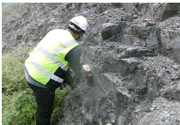
절리면 경사/경사방향 측정
